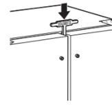
2. Insérer l'outil d'alignement fourni entre les portes pour qu'il s'appuie sur le dessus des portes.
