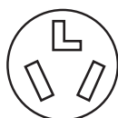
Tomacorriente de 3 hilos (10-30R)
