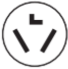
Tomacorriente de 3 hilos (10-30R)
