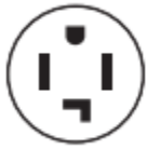
Tomacorriente de 4 hilos (14-30R)
