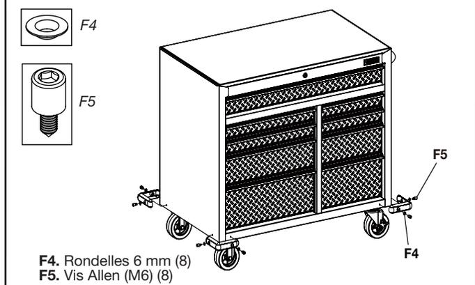
À l'aide des vis Allen de 6 mm (F4) (8) et des rondelles (F5) (8), fixer un protège-coin correspondant à chaque angle de l'établi mobile. Serrer complètement toutes les attaches de fixations.
