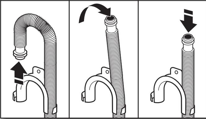
Para las instalaciones con desagüe por el piso, necesitará quitar el molde de la manguera de desagüe del extremo de la misma. Puede ser que necesite piezas adicionales con instrucciones por separado. Vea “Piezas y herramientas”.
