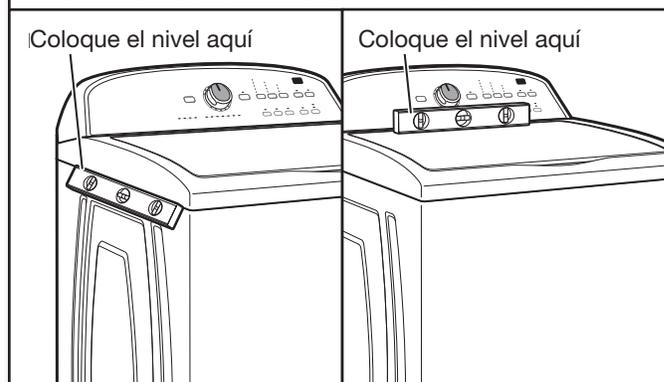
Con la lavadora en su ubicación final, coloque un nivel en los bordes superiores de la lavadora. Use la hendidura lateral como una guía para revise la nivelación de los lados. Revise la nivelación del frente usando la tapa, como se muestra. Balancee la lavadora hacia delante y hacia atrás para asegurarse de que las 4 patas hagan contacto firme con el piso. Si la lavadora está nivelada, saltee al paso 15 (en los modelos con las patas de metal o al paso 16 (en los modelos con las patas plásticas).
