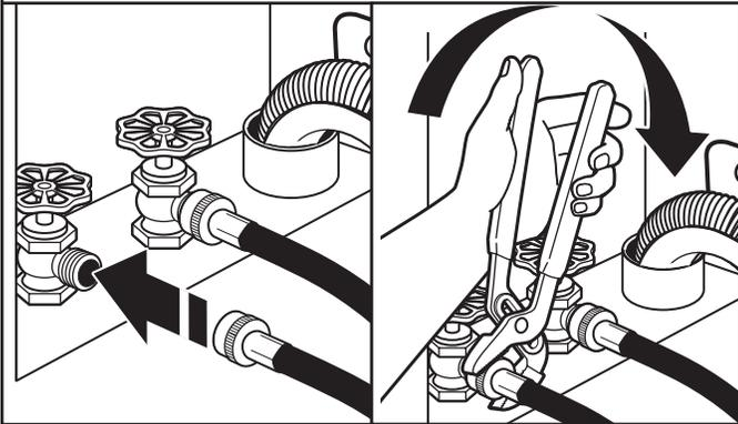
Sujete la manguera al grifo de agua caliente. Atornille el acoplamiento con la mano hasta que quede asentado en la lavadora. Use pinzas para apretar los acoplamientos dos tercios de vuelta adicional. Repita este paso con la segunda manguera para el grifo de agua fría.
