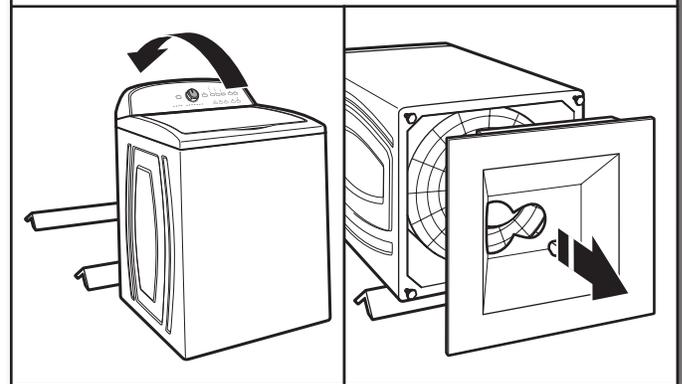
Para evitar dañar el piso, coloque los soportes de cartón de la caja de embalaje sobre el piso detrás de la lavadora. Incline hacia atrás la lavadora y colóquela sobre los soportes de cartón. Quite la base de embalaje. Coloque la lavadora en posición vertical.
