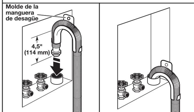
Coloque la manguera dentro del tubo vertical (se muestra en la ilustración) o sobre el lado de la tina de lavadero.
