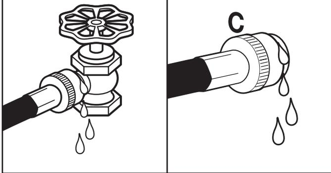
Abra los grifos del agua para revise si hay fugas de agua en el grifo y en la conexión a la lavadora. Una pequeña cantidad de agua podría entrar en la lavadora. Ésta se desaguará más tarde.
