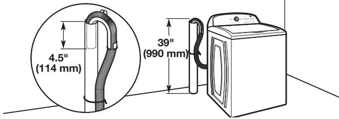
Diámetro mínimo para el desagüe de tubo vertical: 2" (51 mm). Capacidad de desplazamiento mínima: 17 gal. (64 L) por minuto. La parte superior del tubo vertical debe estar a 39" (991 mm) de altura como mínimo; instálela a no más de 96" (2,4 m) de la base de la lavadora. Si la instala a más de 96" (2,4 m), necesitará un sistema de bomba de sumidero.
