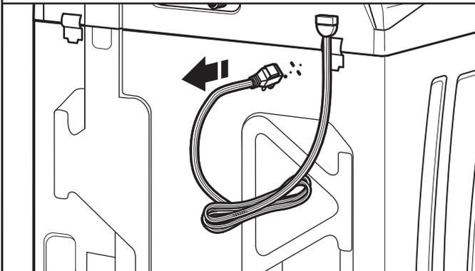
Sujete con firmeza el cable eléctrico y jálelo para liberarlo por completo del panel posterior. Después coloque el cable eléctrico con cuidado sobre la consola para permitir un acceso sin obstrucciones a la parte posterior de la lavadora.
