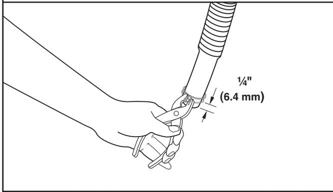
Vérifier que le tuyau de vidange a la bonne longueur. Mouiller la surface intérieure de l'extrémité rectiligne du tuyau de vidange avec de l'eau du robinet.
