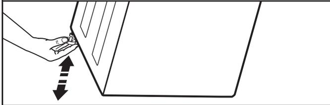
Incliner la laveuse/sécheuse vers l'avant. Faire bouger chacun des 2 pieds arrière vers le haut puis vers le bas pour vérifier que les pieds de nivellement auto-réglables peuvent bouger librement. Ceci est nécessaire pour une mise à niveau correcte. Reposer doucement la laveuse/sécheuse sur le plancher.
