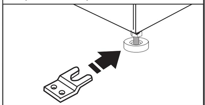
**Pour utilisation en maison mobile :** Les laveuses/sécheuses avec sècheuses à gaz doivent être bien fixés au sol.
