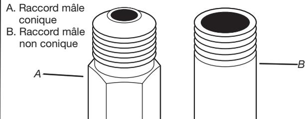
Retirer le capuchon rouge de la canalisation d'arrivée de gaz. Enlever l'adaptateur 1/2" NPT du raccord flexible. (Il sera nécessaire d'utiliser deux clés à molette.) À l'aide d'une clé pour serrer, raccorder l'alimentation en gaz à la laveuse/sécheuse. Utiliser un composé d'étanchéité des tuyauteries sur tous les filetages des raccords mâles non coniques. Si on utilise un conduit métallique souple, veiller à ce qu'il ne soit pas pincé.
