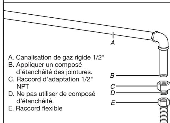
Installer l'adaptateur sur le raccord 1/2" de la canalisation de gaz rigide; utiliser un composé d'étanchéité des jointures.
