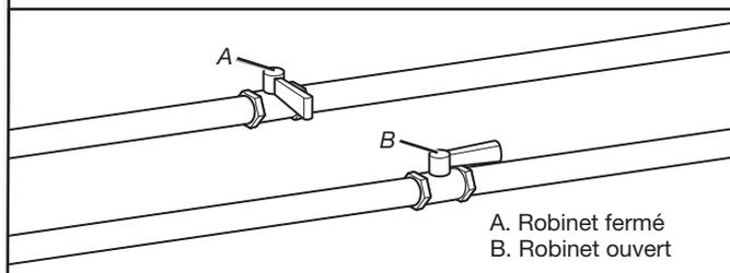
Ouvrir le robinet d'arrêt de l'alimentation. Le robinet est ouvert lorsque la poignée est parallèle au conduit d'alimentation en gaz. Vérifier tous les raccordements en les badigeonnant d'une solution de détection des fuites non corrosive approuvée. L'apparition de bulles indique une fuite. Réparer toute fuite éventuelle.
