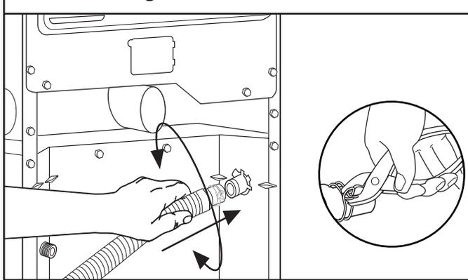
Ouvrir la bride de serrage. Tourner le tuyau d'un côté et de l'autre en poussant sur le raccord de vidange sur le côté de la laveuse/sécheuse. Continuer jusqu'à ce que le raccord touche les butées nervurées sur le placard. Placer la bride à l'endroit indiqué "CLAMP". Relâcher la bride.
