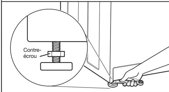
Si la laveuse/sécheuse n'est pas d'aplomb, utiliser une clé plate ou une clé à molette de 9/16" ou 14 mm pour tourner les contre-écrous dans le sens horaire jusqu'à ce qu'ils se trouvent à environ 1/2" (13 mm) de la caisse de la laveuse/sécheuse. Tourner ensuite le pied de nivellement dans le sens horaire pour abaisser la laveuse/sécheuse ou antihoraire pour la soulever. Contrôler à nouveau l'aplomb de la laveuse/sécheuse et répéter au besoin.
