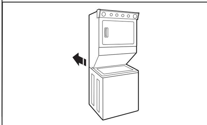
Déplacer la laveuse/sècheuse à son emplacement final, en faisant attention à ne pas déformer ou écraser le conduit d'évacuation.
