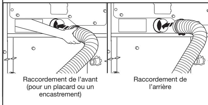
À l'aide d'une bride de serrage de 4" (102 mm), relier le conduit d'évacuation à la bouche d'évacuation de la sècheuse. Si on utilise le conduit d'évacuation existant, s'assurer qu'il est propre. Le conduit d'évacuation de la sècheuse doit être fixé par-dessus la bouche d'évacuation et à l'intérieur du clapet d'évacuation. Vérifier que le conduit d'évacuation est fixé au clapet d'évacuation à l'aide d'une bride de serrage de 4" (102 mm).
