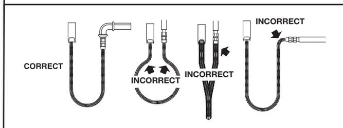
Connecter le raccord flexible sur l'adaptateur 1/2" NPT. Ne pas appliquer de composé d'étanchéité sur cette connexion.
