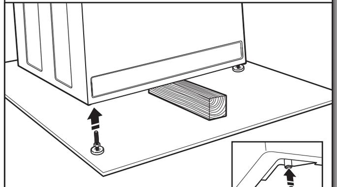
Visser les pieds dans les trous filetés au coin avant de la laveuse/sécheuse jusqu'à ce que les contre-écrous touchent la laveuse.
