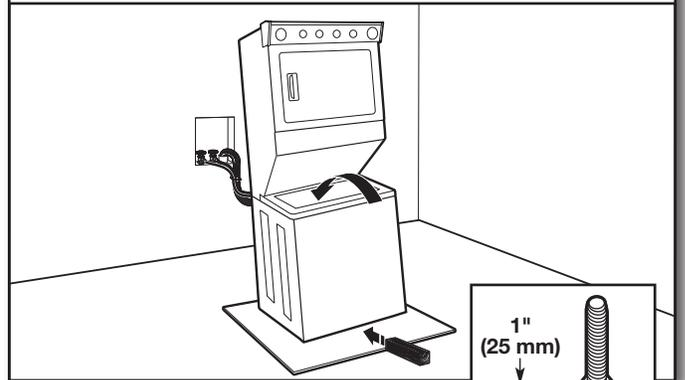
Relever l'avant de la laveuse/sécheuse d'environ 4" (102 mm) à l'aide d'un bloc de bois ou autre objet similaire que peut supporter le poids de la laveuse/sécheuse. Puis, visser le contre-écrou sur chaque pied à 1" (25 mm) de la base.
