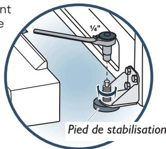
Si les portes sont mal alignées au sommet, les aligner. Pour un bon alignement, effectuer les ajustements une fois les aliments placés dans les portes.
