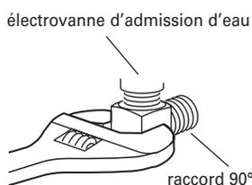
5. Bien serrer le raccord 90°; veiller à orienter le raccord vers l'arrière.
