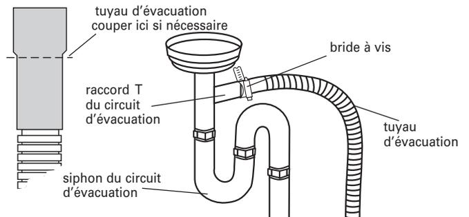
3. Insérer le tuyau d'évacuation à travers le trou découpé dans le placard et acheminer le tuyau jusqu'à l'emplacement de raccordement au lave-vaisselle.
