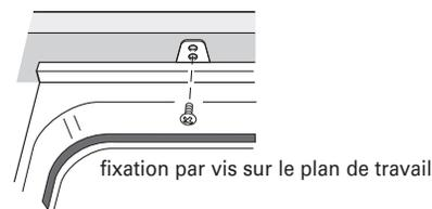
4. Entrouvrir la porte d'environ 3" (7,6 cm) et vérifier que le lave-vaisselle est parfaitement centré dans la cavité d'encastrement (espacement identique à gauche et droite entre le lave-vaisselle et les placards latéraux). Si l'espacement n'est pas identique, desserrer les vis des brides de fixation et déplacer légèrement le lave-vaisselle, puis resserrer les vis de fixation des brides.
