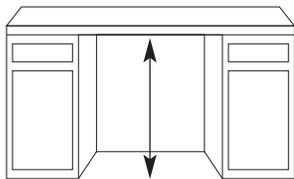
8. Déployer les pieds de réglage de l'aplomb sous la base du lave-vaisselle pour établir une hauteur inférieure de 1/4" à la hauteur libre de la cavité d'encastrement.
