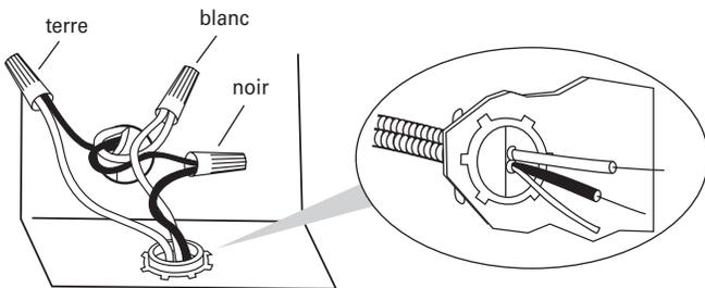
4. Serrer les vis du serre-câble ou du connecteur de conduit.
