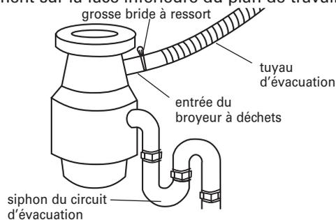
3. Insérer le tuyau d'évacuation à travers le trou découpé dans le placard et acheminer le tuyau jusqu'à l'emplacement de raccordement au lave-vaisselle.
