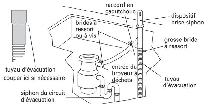
4. Insérer le tuyau d'évacuation à travers le trou découpé dans le placard et acheminer le tuyau jusqu'à l'emplacement de raccordement au lave-vaisselle
