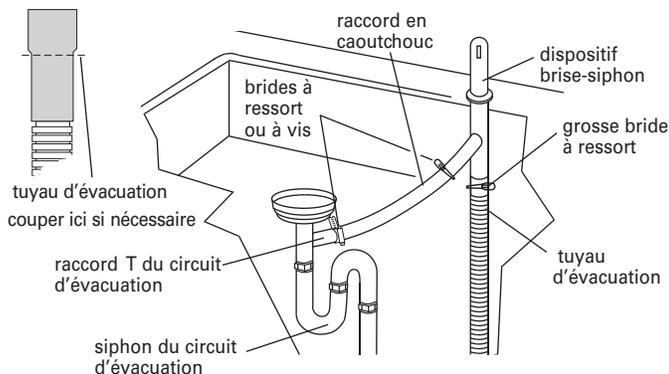
4. Insérer le tuyau d'évacuation à travers le trou découpé dans le placard et acheminer le tuyau jusqu'à l'emplacement de raccordement au lave-vaisselle.
