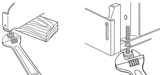
2. Vérifier que chaque pied de réglage de l'aplomb est fermement en appui sur le sol.
