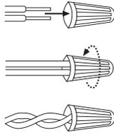
3. Connecter les conducteurs (conducteurs du câble d'alimentation et conducteurs de calibre 16 du lave-vaisselle) comme suit avec des connecteurs de fils de taille appropriée :
