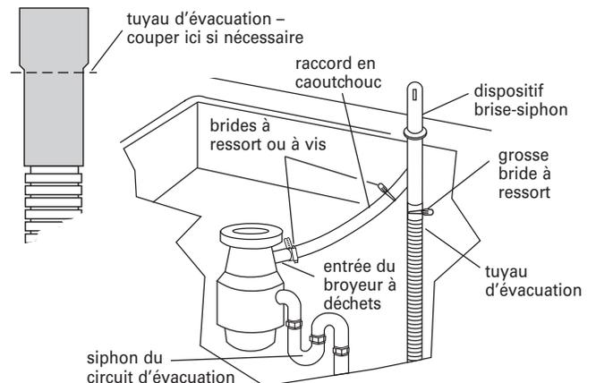
4. Insérer le tuyau d'évacuation à travers le trou découpé dans le placard et acheminer le tuyau jusqu'à l'emplacement de raccordement au lave-vaisselle.
