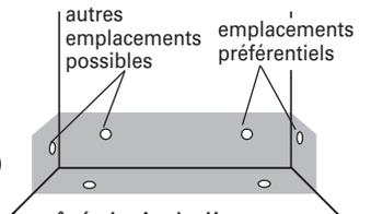
1. Percer un trou de 3/4" (1,9 cm) dans la paroi du placard, le mur arrière ou le plancher, sur le côté droit de l'espace d'installation. Les emplacements préférés ainsi que les autres emplacements possibles sont identifiés sur l'illustration.
