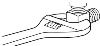
3. Placer un essuie-tout de papier sous le raccord 90°. Ouvrir le robinet d'arrêt de la canalisation d'arrivée d'eau. Inspecter pour rechercher d'éventuelles fuites.
