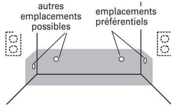
1. Percer un trou de 1 1/2" (3,8 cm) dans la paroi du placard ou le mur arrière. Les emplacements préférés ainsi que les autres emplacements possibles sont identifiés sur l'illustration.
