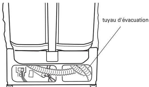
4. Le tuyau d'évacuation comporte une extrémité moulée adaptable sur un orifice de 5/8" (16 mm), 3/4" (18 mm) ou 1" (25,4 mm) sur le brise-vide, raccord de canalisation d'évacuation ou broyeur à déchets; couper sur la ligne marquée appropriée selon la configuration de l'installation.
