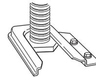
3. Dans le cas de l'installation de la cuisinière dans une résidence mobile, on doit fixer la cuisinière au plancher. Toute méthode de fixation de la cuisinière au plancher est adéquate dans la mesure où elle est conforme aux normes mentionnées à la section "Exigences d'emplacement".
