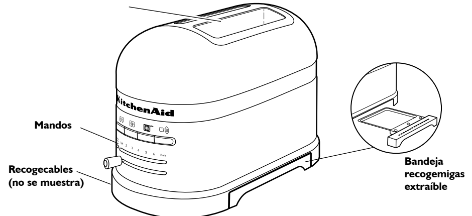
Ranuras extraanchas con rejillas de centrado automático
