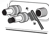
**Limpie al menos una vez al mes los filtros** localizados en la parte trasera, retirando las mangueras y usando un cepillo para eliminar los residuos.
