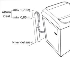
Asegúrese que la salida de la manguera quede de 0,85 a 1,2 metros de altura del suelo.
