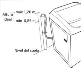
Asegúrese que la salida de la manguera quede de 0,85 a 1,2 metros de altura del suelo.
