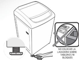
Ajuste las patas niveladoras con ayuda de un nivel.
