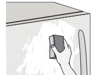
7. Use una pieza de tela seca y frote sobre la superficie húmeda. Se recomienda utilizar un limpiador de acero inoxidable para un acabado brillante.
