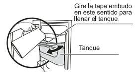
**NOTA:** La tapa pequeña no se retirará completamente de la cubierta del tanque de almacenamiento.
