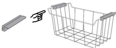
Antes de colocar en la posición B, coloque las 3 barandillas de alambón para poder colocarlos sobre estas. Después siga los siguientes pasos.
