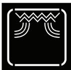
En este modo de asar, las resistencias superiores interna y externa se prenden simultáneamente. La función es indicada para gratinar pastas y legumbres, tostar panes y finalizar platos, intensificando el dorado de la superficie.
