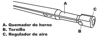
**NOTA: No obstruya la salida de aire del horno, no cubra los orificios de la charola de horno.**
