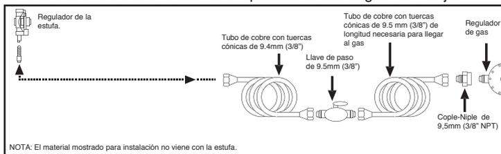
2. Una vez conectado su línea de gas, ABRA el paso de gas y verifique que no existan fugas vertiendo espuma de jabón en las conexiones y curvas de los tubos.
