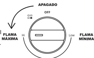
**El dispositivo no se debe accionar por más de 15 s. si después de este tiempo el quemador no se enciende, se debe detener el funcionamiento del dispositivo y abrir la puerta del compartimiento y/o esperar al menos 1 min antes de intentar una nueva ignición del quemador.**
