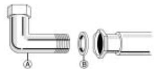
**Atención:** si utiliza tubería de acero inoxidable, deberá instalarla de modo que no toque ninguna parte móvil de los muebles. Deberá pasar a través de un área donde no tenga obstrucciones y donde sea posible revisarla por toda su longitud.
