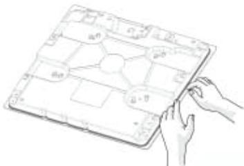
Posicione la parrilla en la abertura de la cubierta de la cocina, respetando las dimensiones indicadas en "dimensiones del producto y espacios de instalación".
