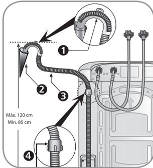
7. Instale la manguera de desagüe en la pileta o en un tubo exclusivo para desagüe, con diámetro de 5 cm. Para instalación en pileta, mantenga la curva plástica que acompaña la extremidad de la manguera.
