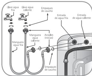
6. Para la entrada de agua a la Lavadora es imprescindible contar con una llave exclusiva de agua fría y otra para el agua caliente (sólo para modelos con agua caliente), que deberán tener una rosca de  $\frac{3}{4}$  de pulgada con 11,5 o 14 hilos por pulgada, dependiendo del país.
