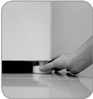
11. Verifique si la Lavadora está correctamente nivelada. Para ello, cargue la Lavadora con agua utilizando el nivel más bajo y verifique si el agua está acompañando los orificios del tambor en una misma línea. En caso que su Lavadora esté desnivelada, regule las patas girándolas. Todas las patas deben estar apoyadas en el piso. Ese procedimiento evitará oscilaciones, ruidos, movimientos y desgaste de su Lavadora.
