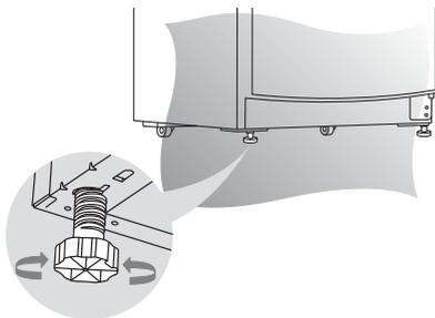
El refrigerador viene por defecto con el tornillo nivelador plástico completamente roscado a una altura de 31 mm con respecto al suelo, y una inclinación de 0.37°. Estas especificaciones son las óptimas por diseño, desempeño y seguridad, si el usuario decide modificar estas dimensiones, lo podrá realizar bajo su responsabilidad.
