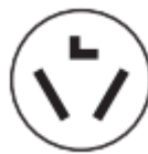
Tomacorriente de 3 hilos (10-30R)
