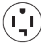
Tomacorriente de 4 hilos (14-30R)
