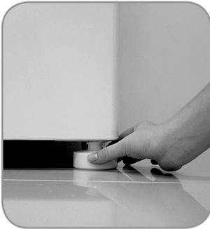
11. Verifique si la Lavadora está correctamente nivelada. Para ello, cargue la Lavadora con agua utilizando el nivel más bajo y verifique si el agua junto a los orificios del tambor está en una misma línea. En caso que su Lavadora esté desnivelada, regule las patas girándolas. Todas las patas deben estar apoyadas en el piso. Ese procedimiento evitará oscilaciones, ruidos, movimientos y desgaste de su Lavadora.
