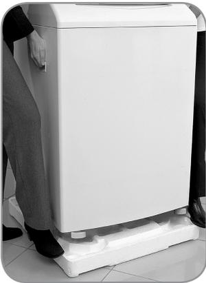
2. Con la ayuda de una persona, retire la base de espuma, levantando la Lavadora de las manijas laterales. Nunca utilice la Lavadora con la base de Espuma Inyectada, pues eso podrá deteriorar su buen funcionamiento y vida útil.
