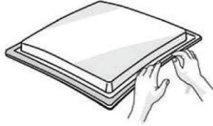
Posicione la parrilla en la abertura de la cubierta de la cocina, respetando las dimensiones indicadas en "dimensiones del producto y espacios de instalación".
