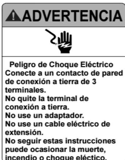
**ATENCIÓN:** No conecte el horno a la alimentación eléctrica antes de terminar la instalación y conexión del aparato y de la superficie de trabajo.
