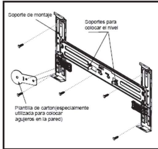
**NOTA:** La forma del soporte de montaje puede ser distinta de que se muestra en la ilustración, pero el sistema de instalación es similar.
