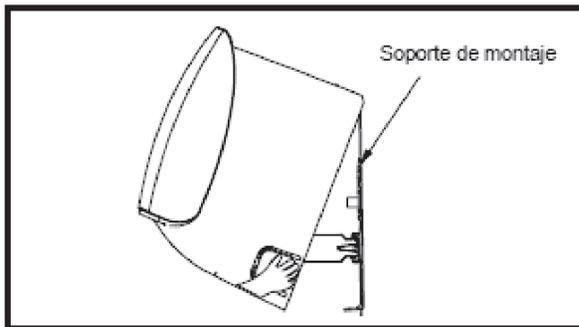
3.- Coloque la unidad interior en posición apoyándolo en los soportes
