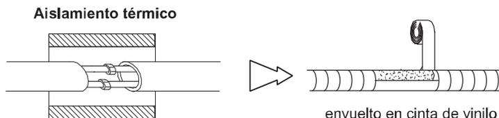
**Aislante térmico en tubería.**
