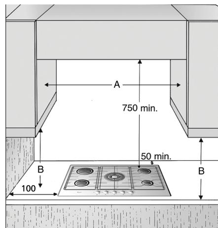
**NOTA:** Si la distancia "A" entre las paredes de los gabinetes está entre 600 y 730 mm, la altura "B" deberá ser de un mínimo de 530 mm. Si la distancia "A" entre las paredes de los gabinetes es más grande que el ancho de la cubierta de la cocina, la altura "B" deberá ser de un mínimo de 400 mm. En caso de instalar una campana de extracción sobre la parrilla, refiérase por favor a las instrucciones de instalación de la campana para revisar las dimensiones de instalación adecuadas.
