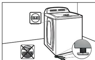
Si su lavadora no se encuentra nivelada ajuste las patas niveladoras.
