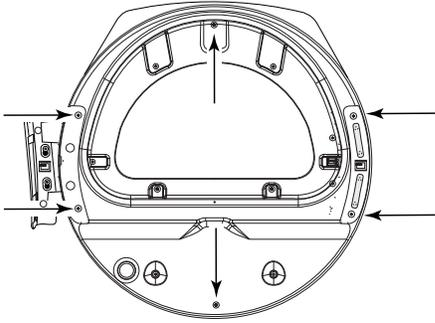
4. Levante el ensamblaje interior de la puerta y sáquelo del ensamblaje exterior de la puerta.
