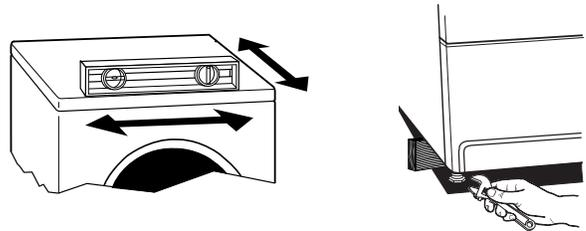
Si la secadora no está nivelada, apunte la secadora, usando un bloque de madera. Use una llave de tuercas para regular las patas hacia arriba o hacia abajo y verifique nuevamente si la secadora está nivelada.
