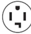
Tomacorriente de 4 hilos (14-30R)
