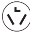
Tomacorriente de 3 hilos (10-30R)
