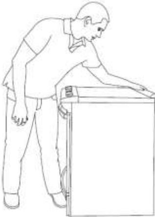
3. Lentamente, intente ladear la estufa hacia adelante. Si siente resistencia inmediatamente, la pata de la estufa esta enganchada en el soporte. Vaya al paso 8.
