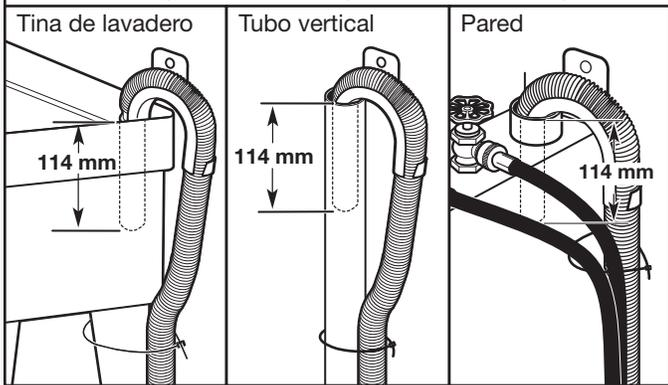
Asegure la manguera de desagüe a la pata del lavadero, al tubo vertical o a las mangueras de entrada para el tubo vertical de pared, utilizando el sujetacables. Esto contribuirá a reducir la posibilidad de que se salpique agua del desagüe en el piso.
