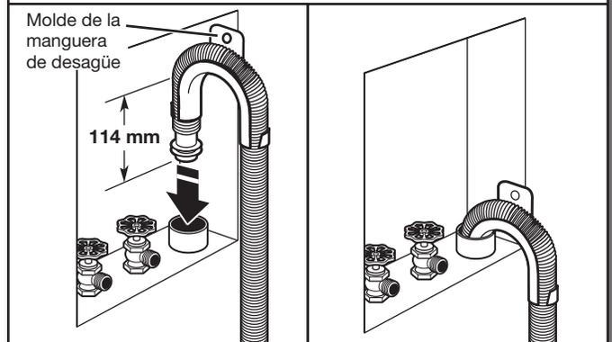
Coloque la manguera dentro del tubo vertical (se muestra en la ilustración) o sobre el lado de la tina de lavadero.
