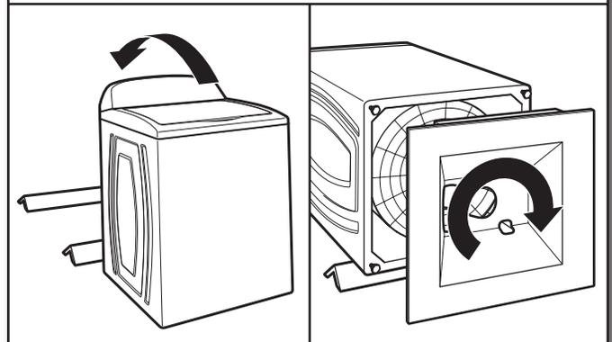
Para evitar dañar el piso, coloque los soportes de cartón de la caja de embalaje sobre el piso detrás de la lavadora. Incline hacia atrás la lavadora y colóquela sobre los soportes de cartón. Quite la base de embalaje rotando la base 90° hacia la derecha. Coloque la lavadora en posición vertical.
