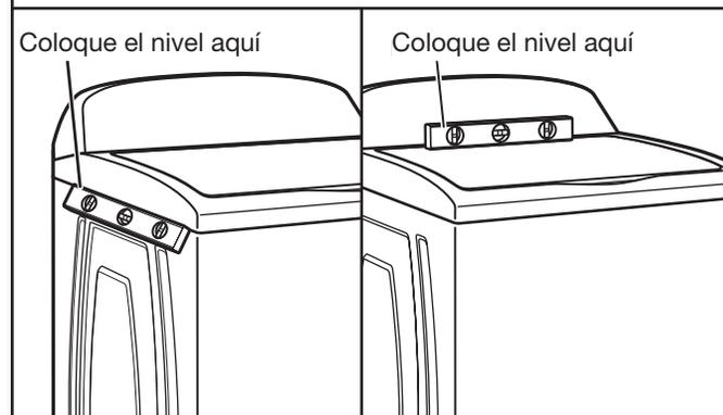
Con la lavadora en su ubicación final, coloque un nivel en los bordes superiores de la lavadora. Use la hendidura lateral como una guía para revisar la nivelación de los lados. Revise la nivelación del frente usando la tapa, como se muestra. Balancee la lavadora hacia delante y hacia atrás para asegurarse de que las cuatro patas hagan contacto firme con el piso. Si la lavadora está nivelada, saltee al paso 15.
