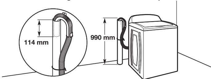
Diámetro mínimo para el desagüe de tubo vertical: 51 mm
